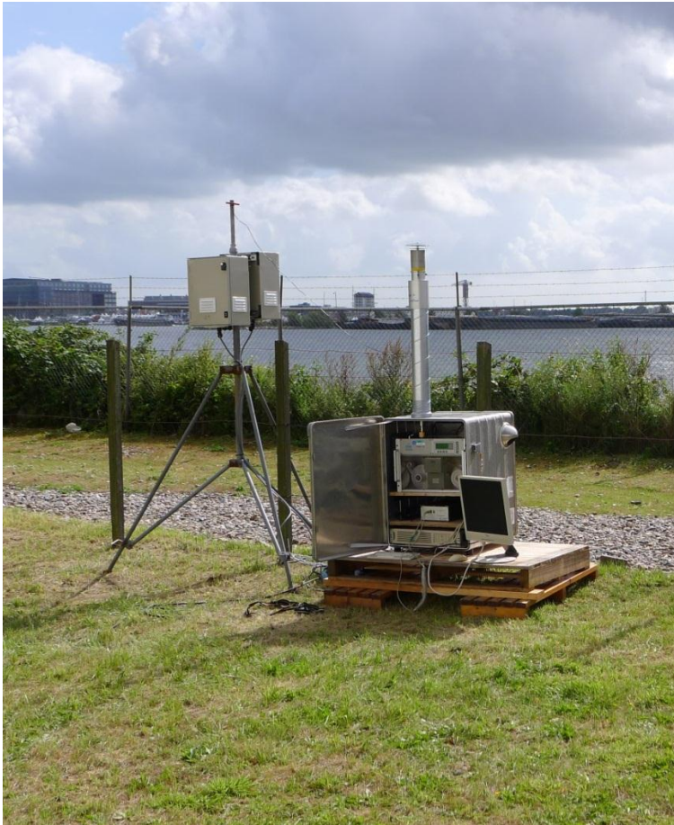
Figuur 3: Het Cargill meetpunt ('2') met de \beta -stofmonitor (rechts) en FSS ('AirBox'; 2x)
