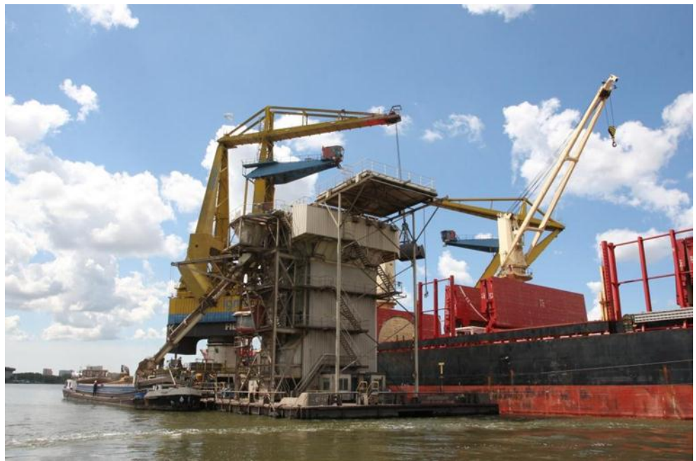
Figuur 1: IGMA silo's en belading binnenschip: Overslag boord-boord met inkomend zeeschip (rechts), kraan/weegcombinatie (midden) en binnenvaartschip (rechts).
